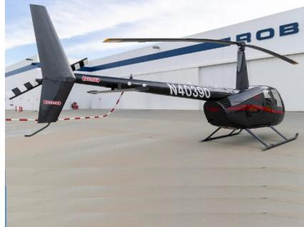
Figure 15 – Empennage d'un hélicoptère
