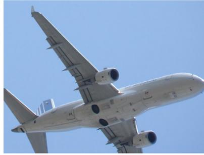
**Figure 17** – Les coffres de roues apparaissent clairement sous le fuselage
