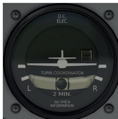
**Figure 52** – Le cadran de l'indicateur de virage et de dérapage
