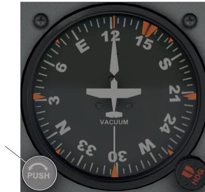
Figure 55 – Le cadran de l'indicateur de direction
