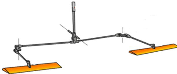
**Figure 25** – Fonctionnement des ailerons
