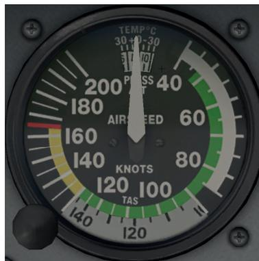
Figure 48 – Le cadran de l'anémomètre
