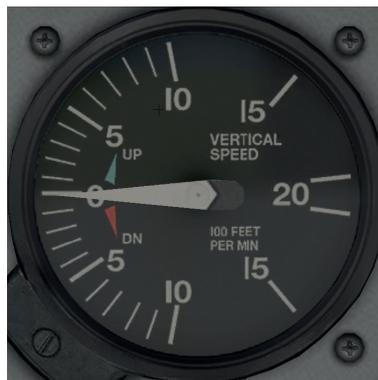
Figure 46 – Le cadran du variomètre
