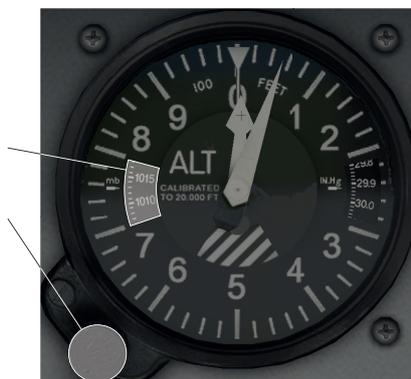
Figure 44 – Le cadran de l'altimètre
