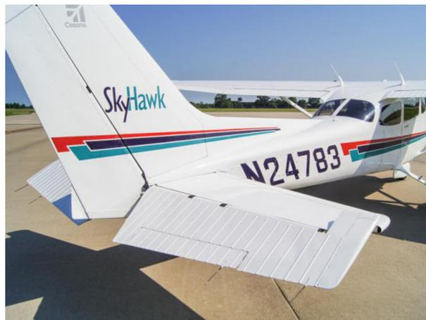
**Figure 27** – Les compensateurs de profondeur et de direction
