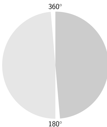
Figure 31 – Illustration de la règle semi-circulaire pour le vol VFR.
