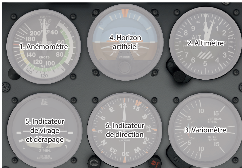
Figure 43 – Les six instruments du tableau de bord standard
